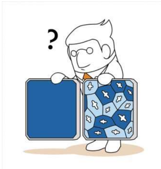
Abbildung 2: Monokristallin (links); Polykristallin (rechts); https://www.photovoltaik.info/poly-oder-mono-was-ist-der-unterschied-was-ist-besser/
