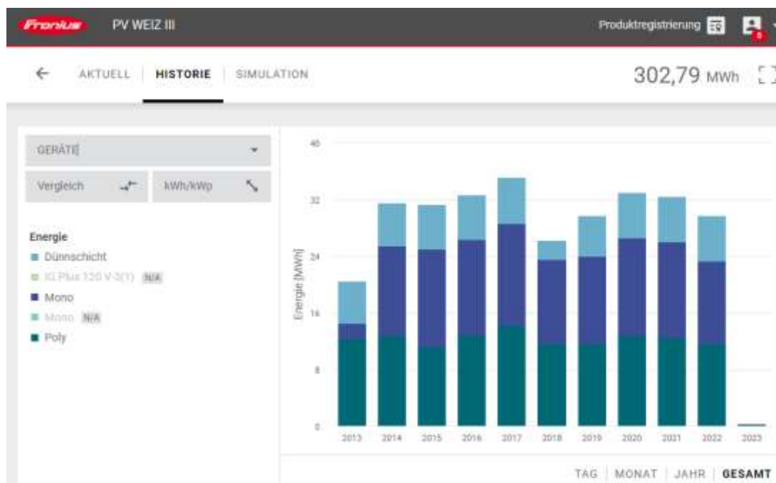
Abbildung 12: Fronius - Energiedarf pro Jahr, verschiedene PV-Modulsysteme, W.E.I.Z.
